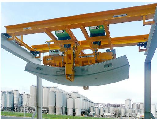
Im Einsatz: Das Heben der schweren Schalungselemente erfolgt über Luftvakuen
