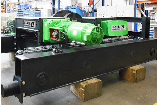
Im STAHL CraneSystems-Werk in Künzelsau werden die AS 7 in Zwillingausführung gefertigt.
