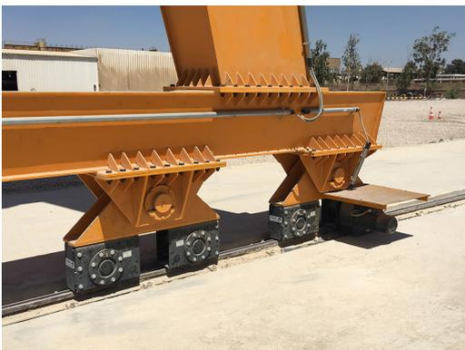
Auf insgesamt 32 Radblöcken werden die beiden Portalkrane verfahren. Dabei sind 8 frequenzgeregelter Fahrtriebe im Einsatz.
