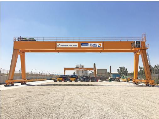
Die beiden AS 7-Zwillingszüge heben bis zu 140 Tonnen schwere Betonteile.
