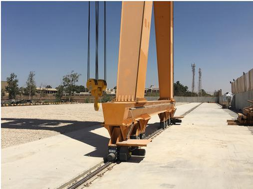
Auf insgesamt 32 Radblöcken werden die beiden Portalkrane verfahren. Dabei sind 8 frequenzgeregelte Fahrtriebe im Einsatz.
