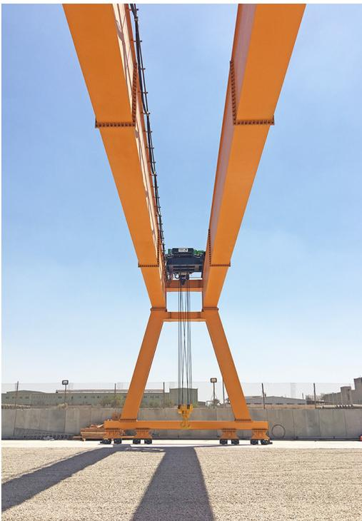
Durch die gleichzeitige, gegenläufige Seilführung des Zwillingshubwerks wird die Last ohne Hakenwanderung gehoben und gesenkt und kann exakt positioniert werden.
