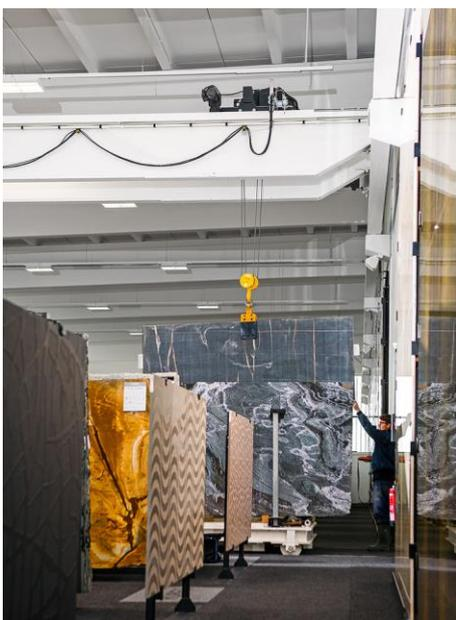
Im Überlappungsbereich der Krane dient ein Schienenwagen zum Quertransport von Steinplatten in die benachbarte Halle.
