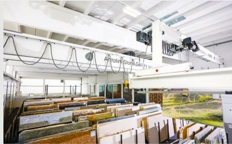
Freitragende Konstruktion: Die neue Kranbahn ragt mehr als 3 Meter in den breiteren Hallenteil hinein. Dieser Bereich kann von beiden Kranen bedient werden.
