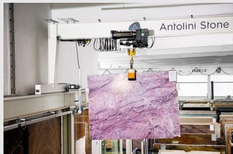
Die Kranbrücke wurde auf einer Seite hochgezogen – eine Sonderkonstruktion von Stahl- und Kranbau Oeder.
