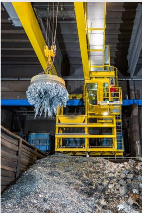
Pro Hubvorgang können 5 Tonnen Metall mit dem Magnetgreifer angenommen werden. Die Stellplätze für die Materialcontainer befinden sich unterhalb der Kranbrücke, was kurze Wege beim Beladen ermöglicht.
