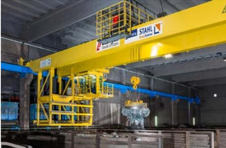
Bei der Gattierung bewegt sich der Portalkran mit bis zu 63 m/min durch die Halle der Grundstoffmischanlage um die Lagerbunker anzufahren.
