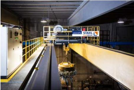
Dank kompakter Abmessungen von Fahrwerk und Seilzug konnte die neue Krananlage in die bestehende Halle integriert werden und trotzdem die benötigte Hubhöhe bieten.
