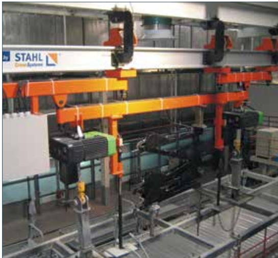
In einer Beschichtungsanlage für die Automobilindustrie in China arbeiten 48 speziell ausgeführte ST Kettenzüge bei sehr hoher Luftfeuchtigkeit.
