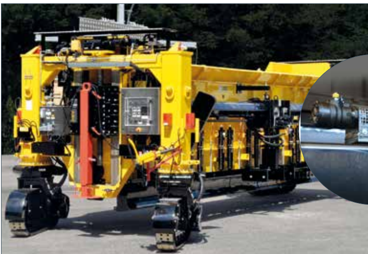
Spindelhubelemente Baureihe SHE von Pfaff-silberblau sorgen in den neuesten Einbauböhlen eines weltweit agierenden Maschinenbau-Unternehmens für einen zuverlässigen Betrieb.
