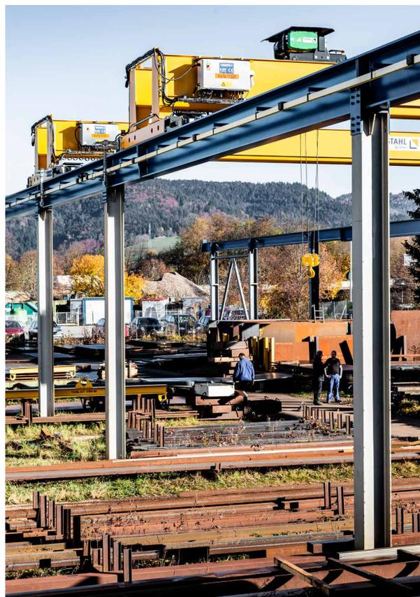
Um der Zunahme von Menge und Gewicht des umgeschlagenen Materials gerecht zu werden, wurde die Krananlage im Lagerbereich der Stahlbau Schauenberg GmbH im südbadischen Kirchzarten mit zwei Zweiträgerbrückenkranen mit 20 Metern Spannweite und jeweils 10 Tonnen Tragfähigkeit modernisiert.
