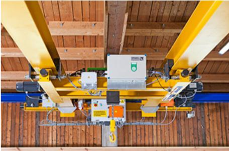
Kompakte Konstruktion: Die Gesamthöhe des Kranes beträgt gerade einmal 57,8 Zentimeter. Mit an Bord: Funkempfänger für eine komfortable Bedienung. Statt störender Schleppkabel kommen für die Stromversorgung Schleifleitungen entlang der Kranbrücke zum Einsatz.
