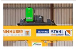
In enger Absprache zwischen Brunnhuber und STAHL CraneSystems entstand eine verschleißarme Lösung des Seiltriebs. Basis der Sonderlösung ist der bewährte Seilzug SH 60, der für diesen Kran mit zweirilliger Seiltrommel produziert wurde.
