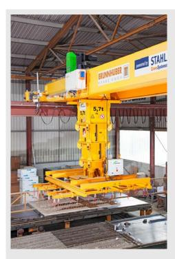
Spezieller Stapelkran von Brunnhuber mit Komponenten von STAHL CraneSystems: Per Teleskop-Hubmast werden die bis zu 5,7 t schweren Betonelemente aus der Produktionsstraße auf Transportwagen gehoben.
