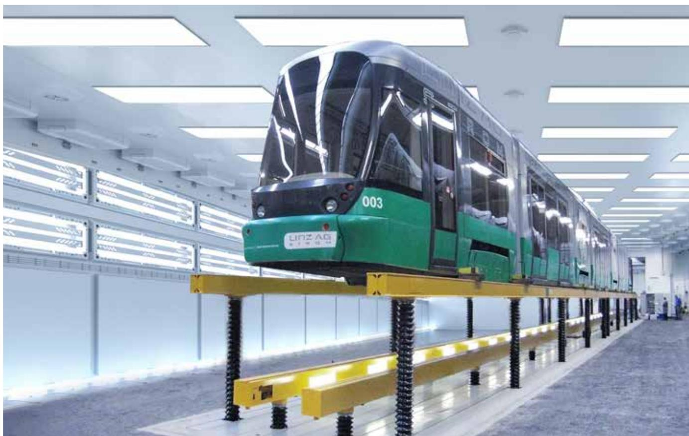
Installation de levage en fosse de la marque Pfaff avec des éléments de levage à vis SHE 25 conçus conformément à la norme DIN EN 1493.
