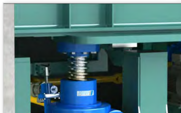
Pfaff-silberblau – 500-Tonnen-Hubanlage zur Verstellung von Zinköfen
